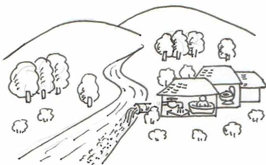
個人下水道といわれる合併浄化槽だと、家庭の排水を、家庭できれいに処理して、川にもどしていきます。
